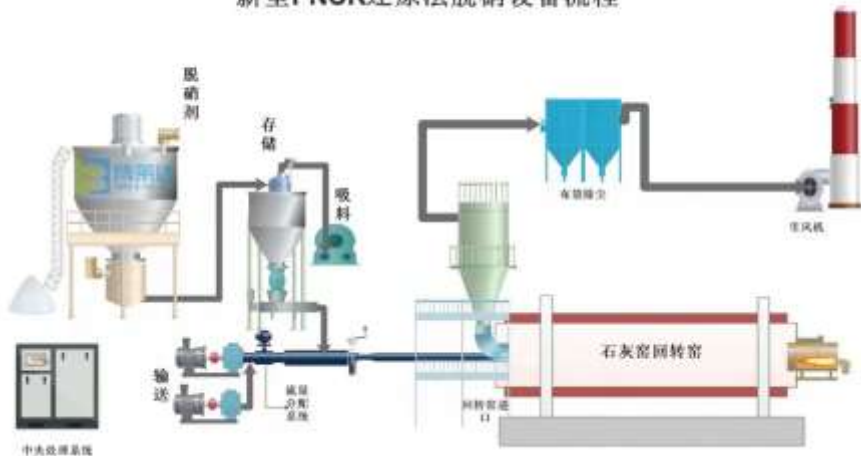
新型PNCR还原法脱硝设备流程
